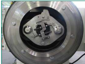
مجهز به سیستم تنظیم خودکار رولر با قابلیت تنظیم فاصله بین رولرها بدون متوقف کردن تولید و خاموش کردن دستگاه
